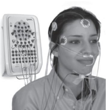
*Рис. 3. 77-канальная (14 параметров) расширенная стационарная полисомнографическая система Grael (Comptomedics, Австралия). Система позволяет проводить полисомнографию, мониторинг видео-ЭЭГ, стандартную электроэнцефалографию.*
