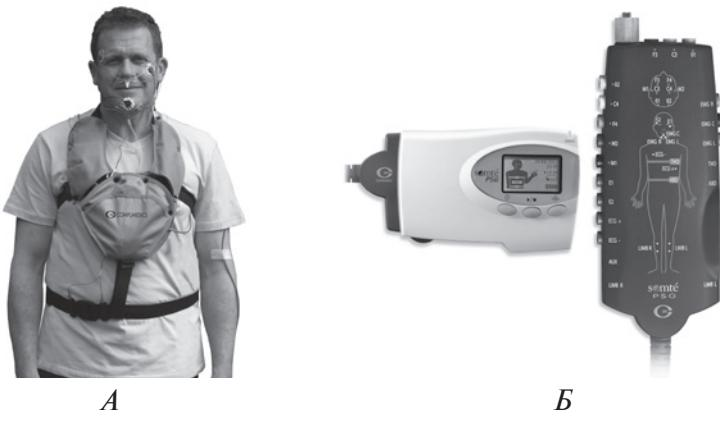
Рис. 2. 24-канальная (13 параметров) полисомнографическая система Somte PSG (Comptomedics, Австралия) с беспроводной передачей данных через bluetooth на компьютерную станцию.
